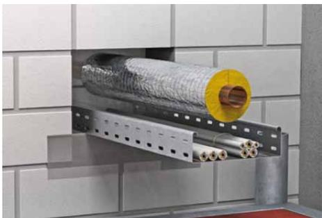
Pode ser instalado em aberturas com eletrodutos e tubulações de gás.
